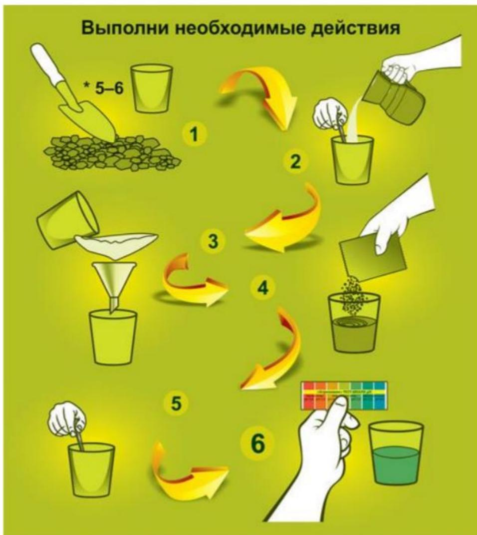
Тест-система «Агрохимик» для определения кислотности почвы (с воронкой)
